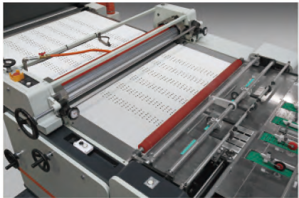
Transmission Tension control and transmission by servo motor + synchronous belts, high accuracy and little noise. Transmisión Control de tensión y transmisión por servo motor + correas síncronas, alta precisión y poco ruido.
